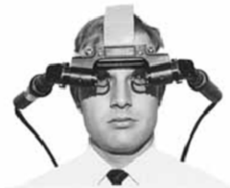
Figura 1.2. Head-mounted display desenvolvido por Ivan Sutherland.
