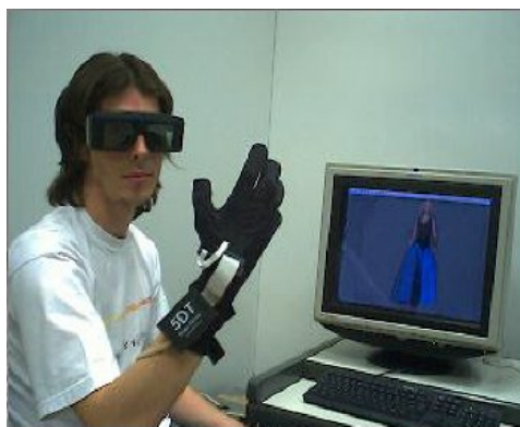
Figura 1.8. Realidade virtual não imersiva com óculos ativos e luva.
